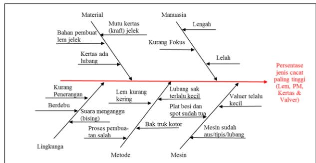
Gambar 7. Diagram Ishikawa penyebab cacat proses pengantongan semen
