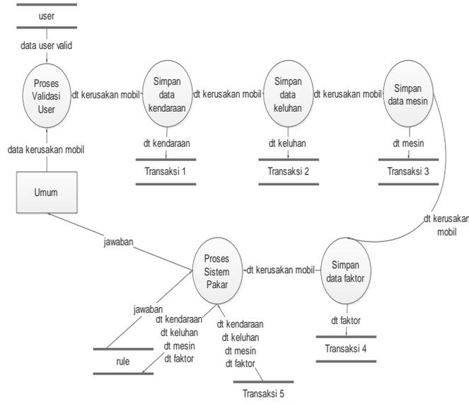
Gambar 6 DFD Level 2 Untuk Proses Diagnosa Kerusakan Mobil
