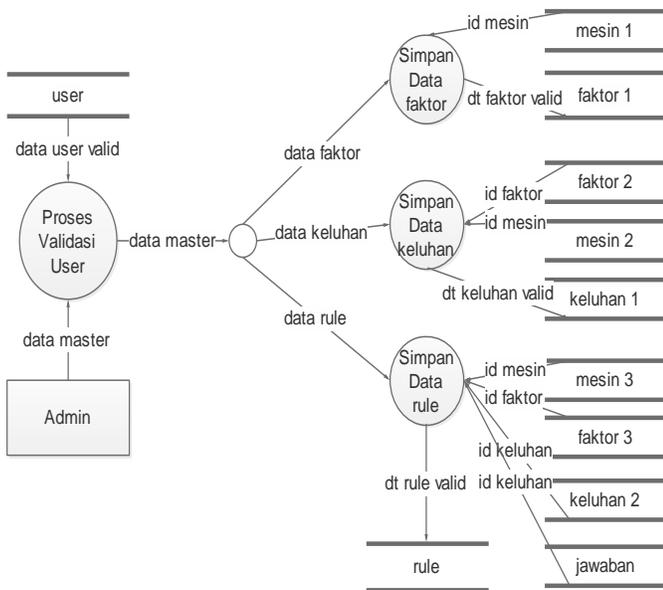
Gambar 5 DFD Level 2 Untuk Proses Maintenance
