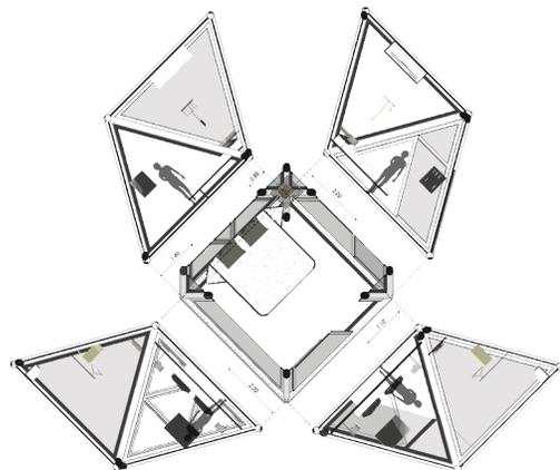
Gambar 6. Aksonometri ruangan (unit kamar): geometri dinding yang terbentuk akibat adaptasi terhadap batang-batang *space frame*
