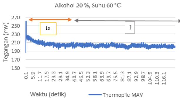
Gambar 16. Bentuk Tegangan *Thermopile* saat tabung berisi alkohol 20%
