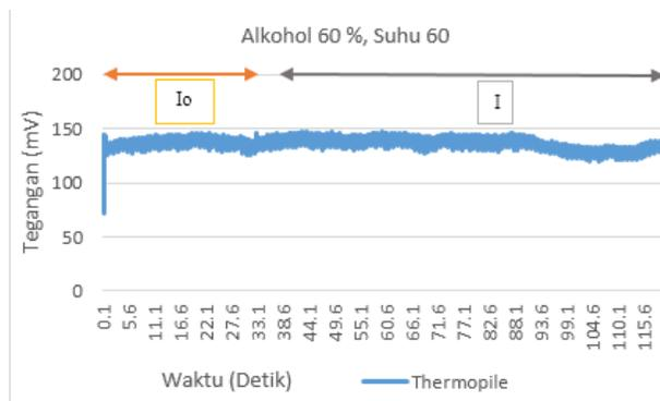
Gambar 17. Bentuk Tegangan *Thermopile* saat tabung berisi alkohol 60%
