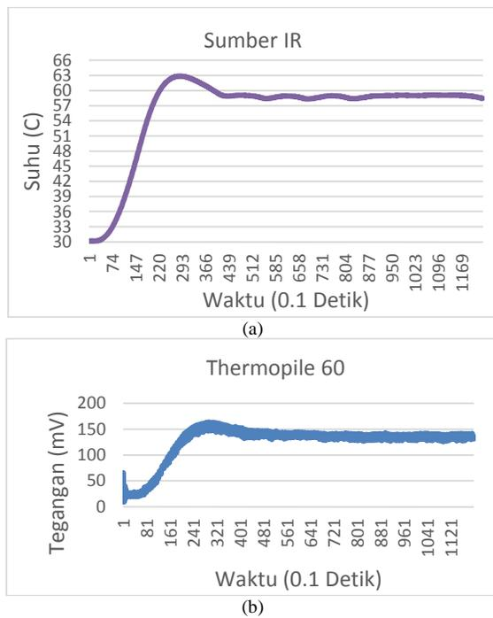
Gambar 11. (a) Grafik Kawat suhu 60°C, (b) Grafik tegangan *Thermopile*
