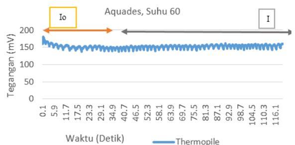
Gambar 15. Bentuk Tegangan *Thermopile* saat tabung berisi aquades
