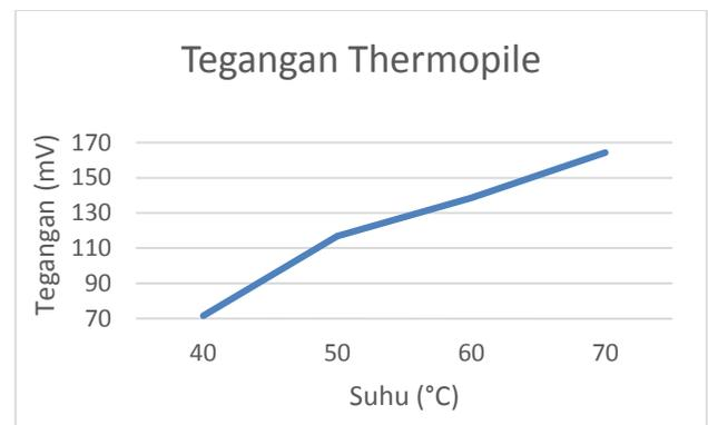
Gambar 12. Tegangan *Thermopile* VS Suhu Sumber IR
