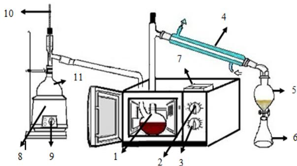
Gambar 2. Skema Alat Metode *Steam-Hydro Distillation* dengan Microwave.
