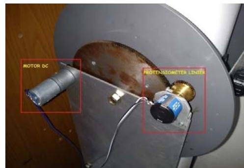
Gambar. 9. Letak pemasangan motor dc dan potensiometer
