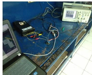
Gambar. 9. Rangkaian Pengujian PWM
