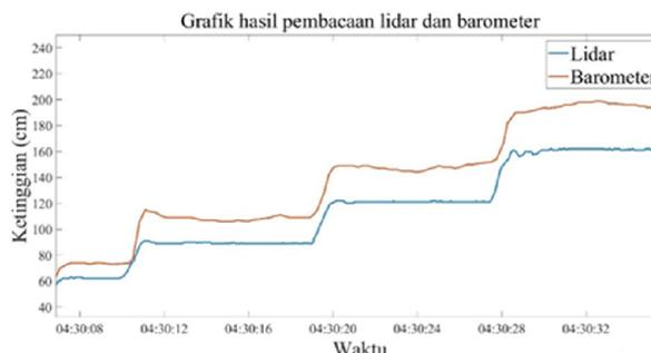
Gambar 8. Perbandingan pembacaan lidar dan barometer.
