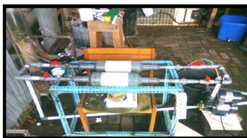
Gambar. 3. Pengujian membran dalam reaktor *cross flow*
