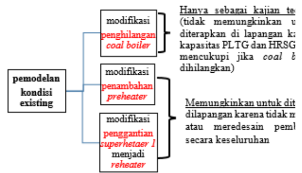
Gambar 2. Bagan rencana pemodelan pembangkit kogenerasi pada software Cycle Tempo.
