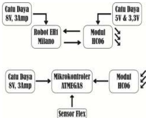
Gambar 5. Diagram blok sistem secara umum
