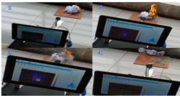
Gambar 13. Pengujian respon sistem, tersulut (1), api membesar (2), api besar dan pompa menyala (3), api padam dan pompa mati (4).
