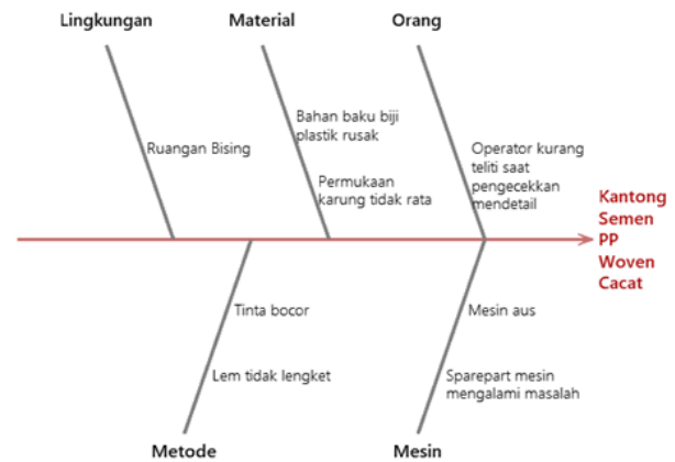
Gambar 7. Identifikasi penyebab kantong semen pasted woven cacat.
