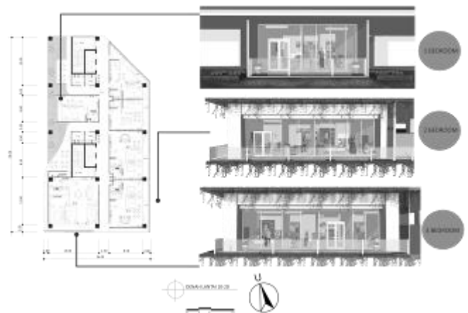
Gambar 10. Denah lantai 10-20 dan area yang menunjukkan letak ketiga tipe unit hunian dengan konsep balkon organik.
