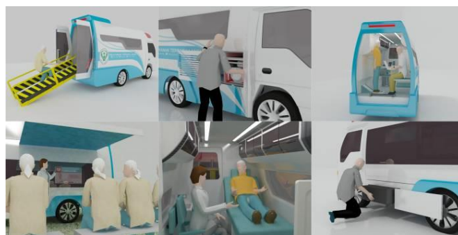
Gambar 9. (a) operasional ramp, (b) operasional genset, (c) operasional pendataan, (d) operasional sosialisasi, (e) operasional pemeriksaan dan (f) operasional air bersih
