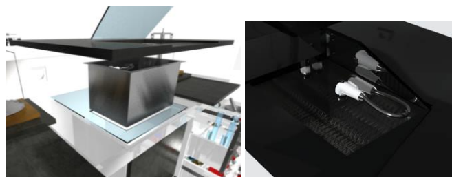
Gambar. 8 Gambar urai struktur paraglass bak cuci tanam dan fleksibel kran
