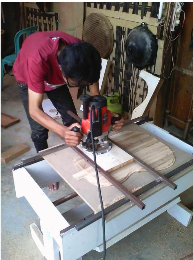
Gambar 6. Proses penipisan soundboard laminasi rotan (sumber:penulis)
