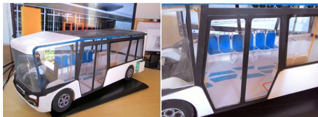
Gambar. 8. Model Bus Listrik Kampus ITS dengan skala 1:10.
