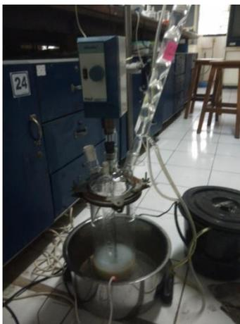
Gambar.1. Rangkaian alat polimerisasi PVAc
