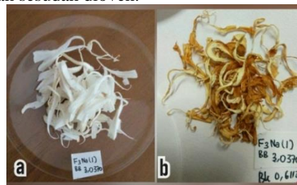
Gambar 3. a. Jamur sebelum dioven, massa: 3,0370 g; b. Jamur setelah dioven, massa: 0,6112 g
