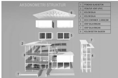
Gambar 4.4 Aksonometri Struktur Bangunan Hostel
