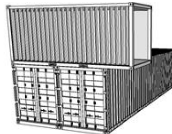
Gambar 4.1 Susunan kontainer berlawanan arah 90 derajat
