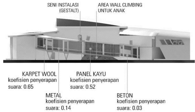
Gambar 12. Material dinding, lantai, dan plafon dengan koefisien penyerapan suara yang berbeda sepanjang jalur ramp (Sumber: data pribadi)
