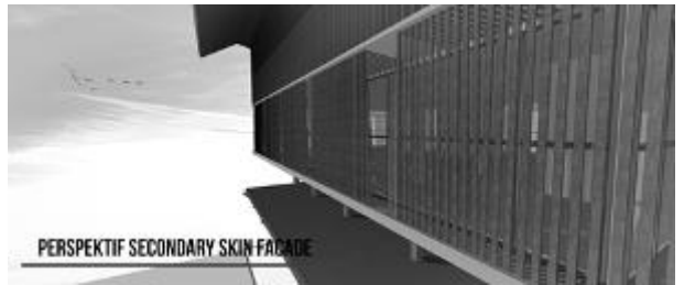
Gambar 12. Double skin façade pada bangunan galeri
