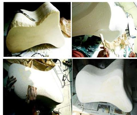
Gambar 8. Proses pembuatan model dimulai dengan membuat cetakan sesuai bentuk dari desain mainan (sumber: Adliyah, 2015)
