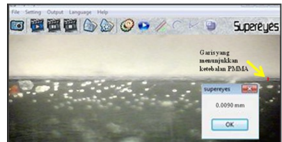
Gambar 6. Hasil pengukuran ketebalan lapisan tipis PMMA
