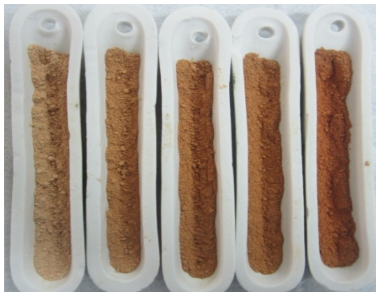
Gambar. 3. Warna padatan katalis hasil kalsinasi pada variasi doping logam: (a) 0,025 mol Fe, (b) 0,05 mol Fe, (c) 0,075 mol Fe, (d) 0,10 mol Fe dan (e) 0,15 mol Fe
