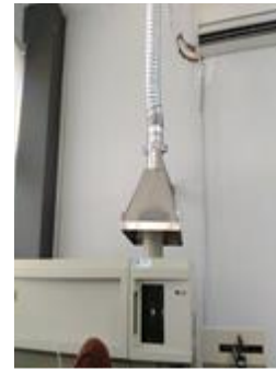
Gambar 8. Pengukuran kadar logam berat kadmium pada Perna viridis menggunakan ICP-OES Prodigy 7.
