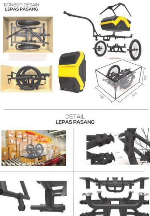
Gambar 7. Menjelaskan konsep desain lepas pasang bike trailer
