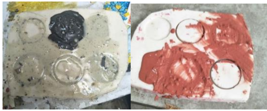
Gambar 5: Pengecoran Beton Cangkang Kerang
