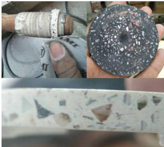
Gambar 6: Pengamplasan Beton Cangkang Kerang.
