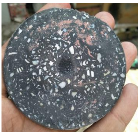
Gambar 2: Test Piece Tekstur dan warna setelah pengurangan permukaan
