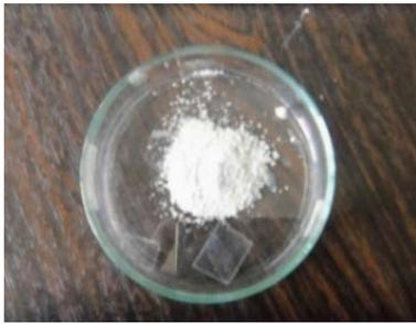
Gambar 1. Contoh serbuk sampel ZMT yang telah dikalsinasi pada temperatur 600°C selama ½ jam.
