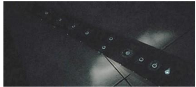
Gambar 9. Resin phosphor akan bekerja ketika terserap cahaya sebelum di kondisi gelap.
