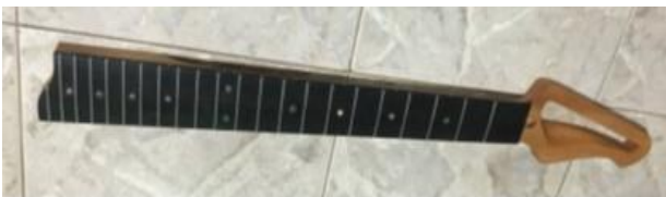
Gambar 8. Hasil akhir neck gitar sebelum assembly.
