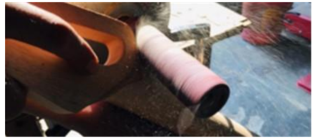
Gambar 3. Pengamplasan awal pada neck gitar.
