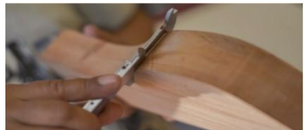
Gambar 11. Pengukuran kontur samping dengan jangka sorong.
