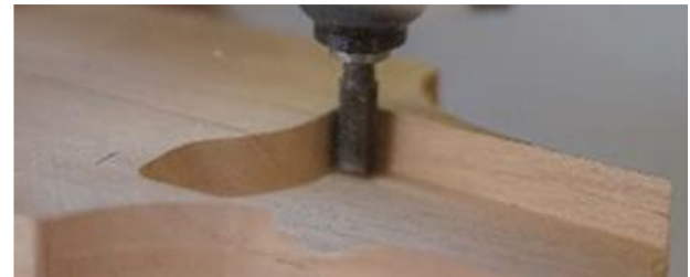
Gambar 10. Proses CNC bodi gitar bentuk dasar 3 axis.
