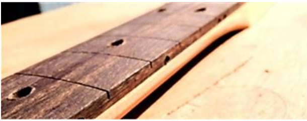
Gambar 6. Pelubangan dot inlay dan fret line.
