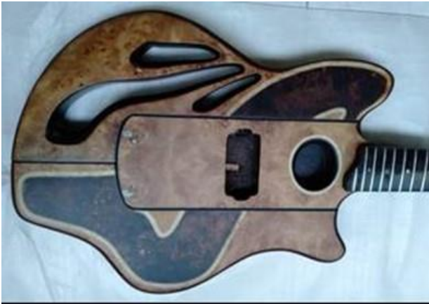
Gambar 17. Modul gitar setelah di finishing menggunakan polyurethane.
