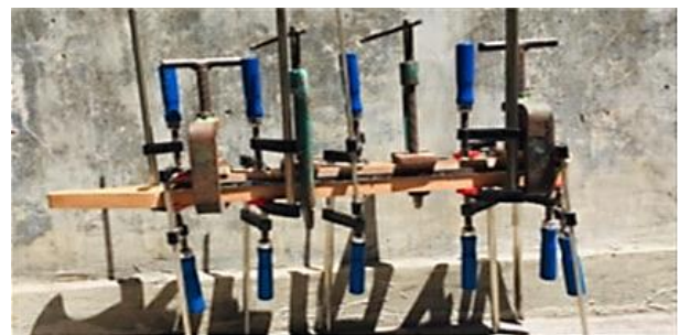
Gambar 5. Proses clamp pada neck gitar.
