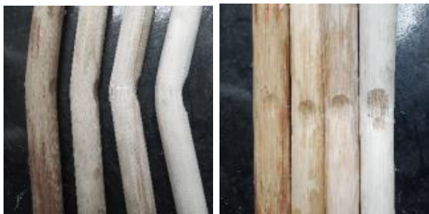
Gambar 4. Kerusakan fisik pada spesimen uji.
