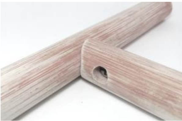
Gambar 7. Pemasangan sambungan cross-dowel.
