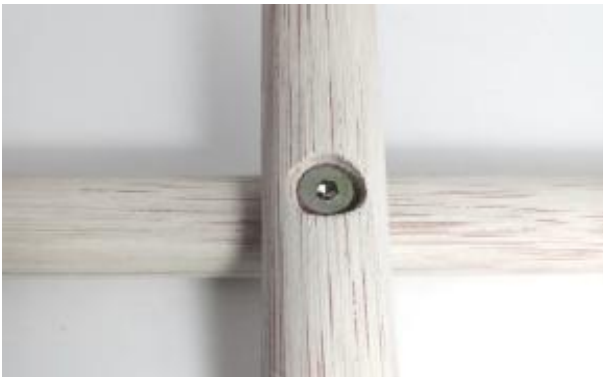
Gambar 8. Pemasangan sambungan Mur nanas.
