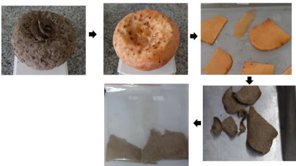
Gambar 2. Alur pembuatan tepung porang berurutan dari umbi porang dikupas, irisan umbi porang, chips kering, dan tepung porang.
