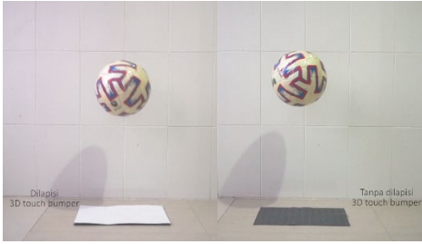
Gambar 26. Material Upper yang Dilapisi Eva (Kiri) Material Upper tanpa Dilapisi eva (Kanan)
