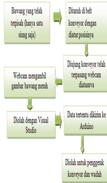
Gambar 2. Desain Alat Pemilah Bawang Merah berdasarkan Ukuran
