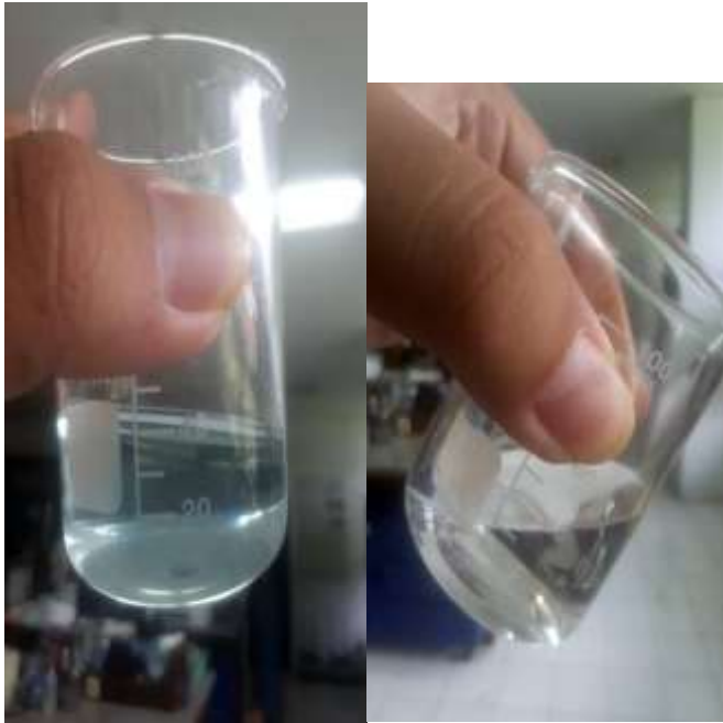
Gambar 1. Larutan standar Cu(II) setelah ditambahkan NaOH 0,1 M 20 tetes (kiri) dan H 2 SO 4 20 tetes (kanan).
