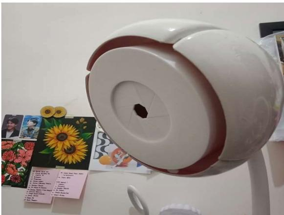
Gambar 11. Sistem iris pada lampu.
