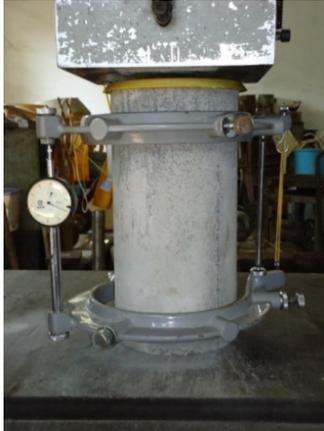
Gambar. 1. Tes Modulus Elastisitas Mortar.
