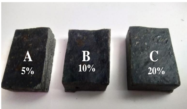
Gambar 4. Spesimen Uji Komposit Kampas Rem Non-Asbestos dengan Presentase Penambahan Selulosa Asetat.
