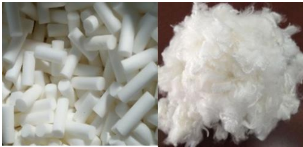
Gambar 3. Serat Selulosa Asetat dari Busa Filter Rokok.
