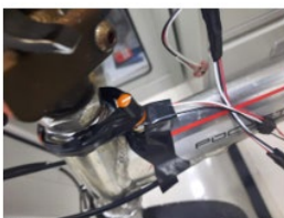
(b) Pemasangan potensiometer
