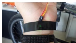
(c) Pemasangan pulse rate
