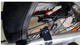
(a) Pemasangan magnet dan halleffect
