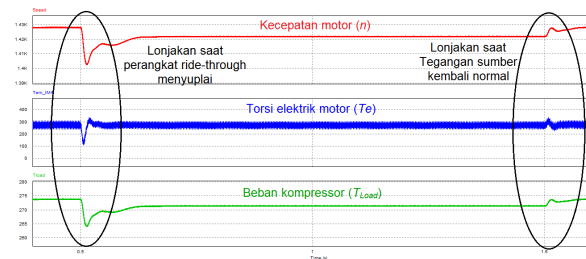
Gambar 25. Lonjakan atau surge pada grafik kecepatan motor, kompresor, dan torsi motor.
