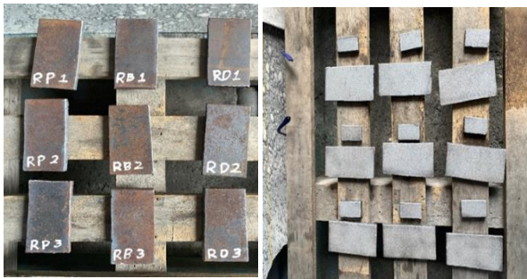
Gambar 3. Material Abrasive sebelum dan sesudah proses Blasting.
