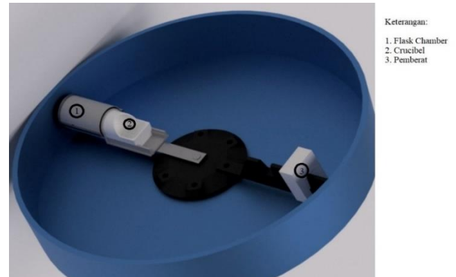
Gambar 1. Skema Alat centrifugal casting bagian flask ditunjukkan oleh nomor 1 crucible pada nomor 2 dan pemat pada nomor 3.
