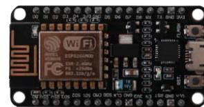
Gambar 3. NodeMCU ESP8266.
