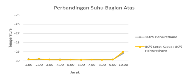
Gambar 13. Grafik perbandingan suhu Reefer Container 20 Feet tanpa beban bagian atas.
