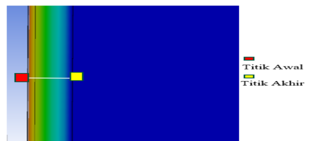
Gambar 6. Garis pengambilan data suhu dinding simulasi FEM.
