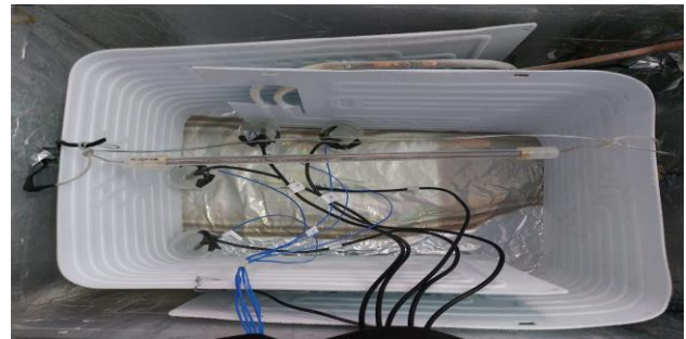
Gambar 3. Peletakan larutan dan termokopel ke dalam cold storage .
