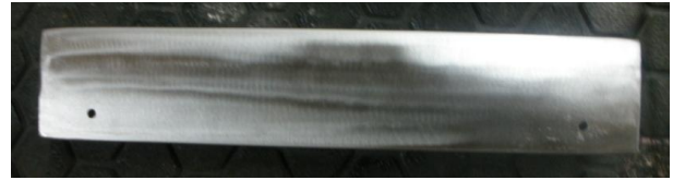
Gambar 2. Blok kalibrasi sesuai ASME [3]
