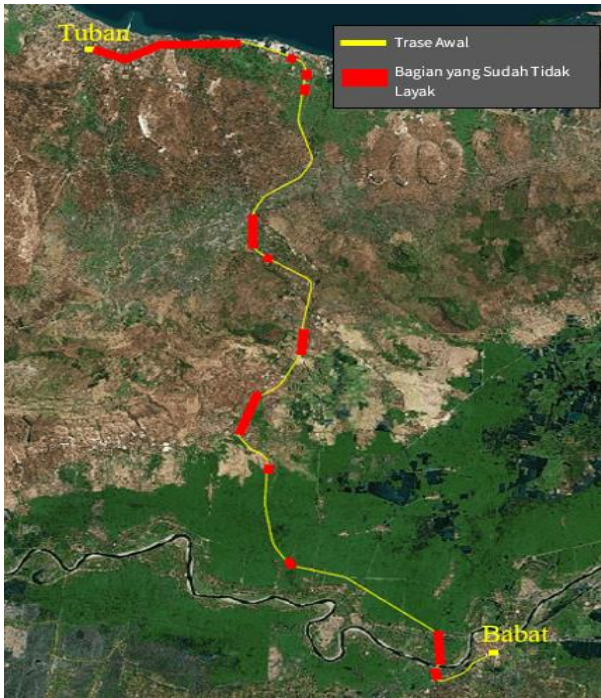
Gambar 4. Bagian trase yang sudah tidak bisa digunakan.
