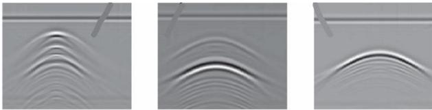
Gambar 2. Contoh Bentuk Anomali Pipa dan Kabel. Anomali Pipa Gas (Sebelah Kiri), Anomali Kabel Bawah Permukaan (Tengah), dan Anomali Pipa Air Bawah Permukaan (Kanan)
