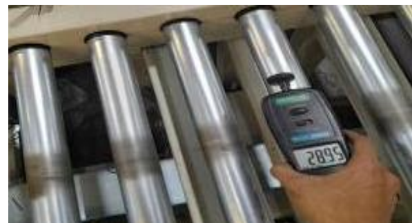
Gambar 7. Pengukuran Kecepatan Conveyor Menggunakan Tachometer.
